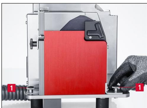
**Figure 7-8** Desserrer les vis moletées de l'unité guide-lame
