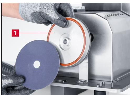
Figure 7-12 Monter une nouvelle paire de disques d'affûtage
