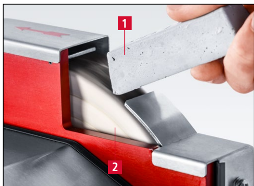
Figure 7-4 Appliquer la pâte à polir
