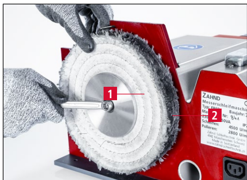
Figure 7-13 Desserrer le disque de polissage
