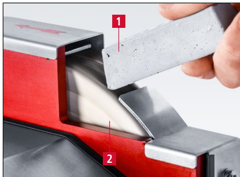
Figure 7-4 Appliquer la pâte à polir
