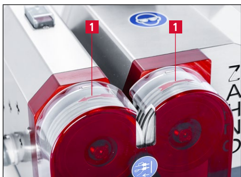
Figure 6-2 Vérifier le sens de rotation
