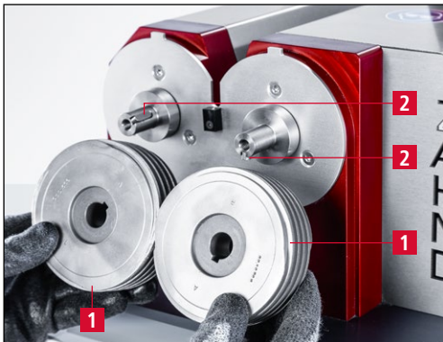
Figure 7-9 Retirer les meules en spirale usées
