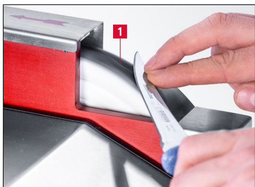
Figure 7-5 Démorfiler et polir un couteau à main
