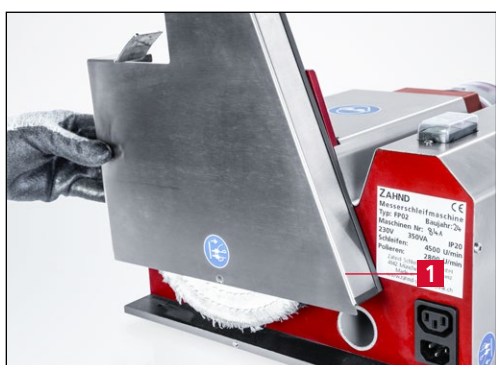
Figure 7-12 Retirer le capot du disque de polissage
