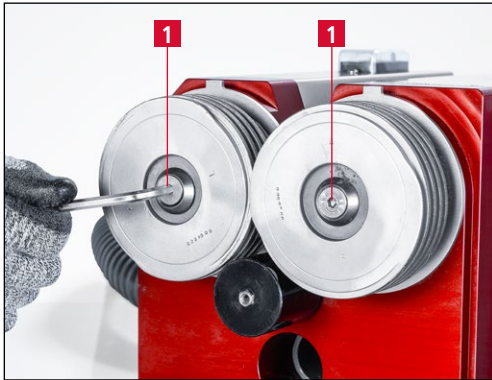
Figure 7-8 Desserrer les vis de serrage
