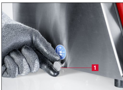
Figure 7-11 Ouvrir la vis moletée
