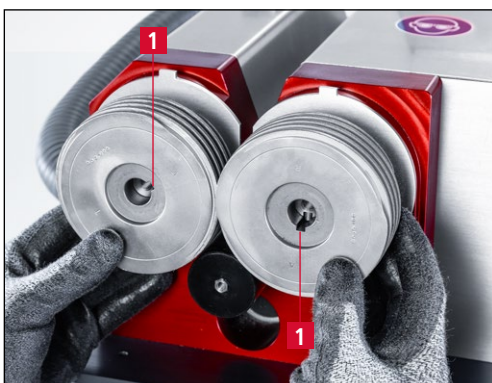
Figure 7-10 Monter les nouvelles meules
