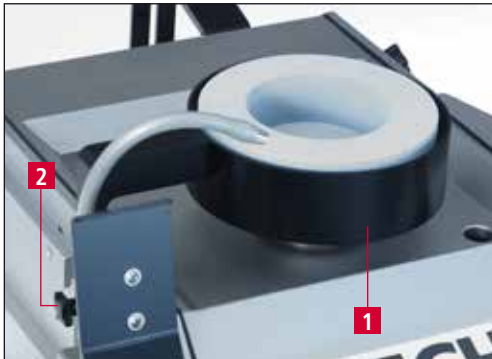
Figure 7-11 Régler la protection du disque d'affûtage
