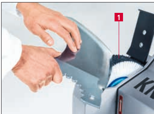
Figure 7-6 Démorfiler et polir le couteau de cutter
