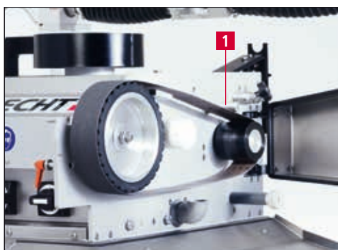
Figure 7-14 Remplacer la bande d'affûtage à eau
