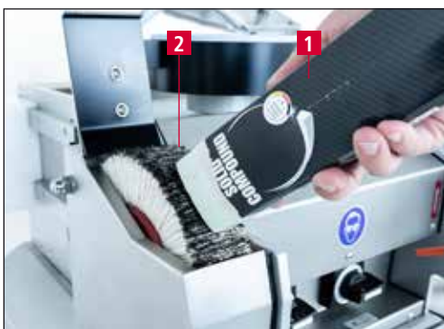
Figure 7-5 Appliquer la pâte de polissage
