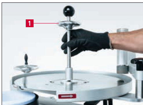
Figure 7-17 Serrage du couteau circulaire
