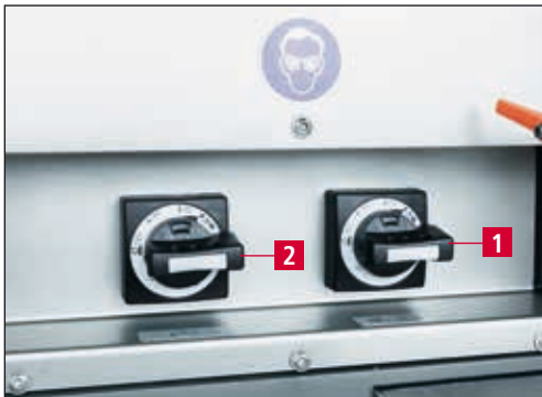
Figure 7-10 Mise en marche de l'affûteuse et du dispositif d'arrosage
