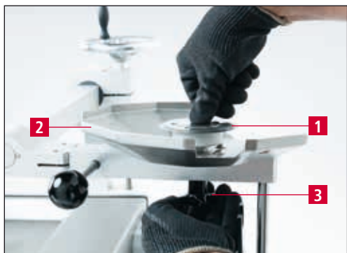
Figure 7-3 Serrage du couteau circulaire
