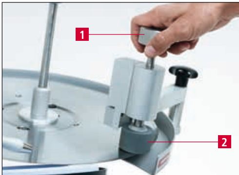
Figure 7-24 Démorfilage du couteau circulaire
