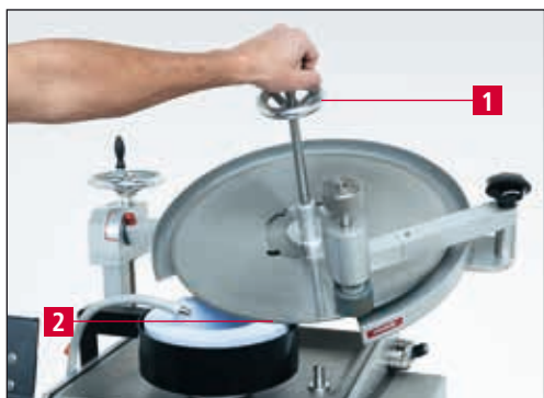
Figure 7-23 Affûtage du couteau circulaire
