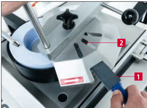
Figure 7-12 Démorfilage du couteau circulaire
