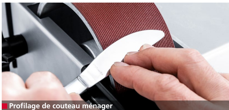
■ Démorfilage / polissage couteau à main sur disque de polissage
