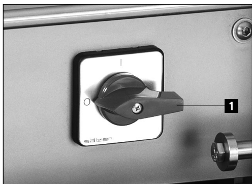
Figure 1-16 Mettre l'affûteuse en marche
