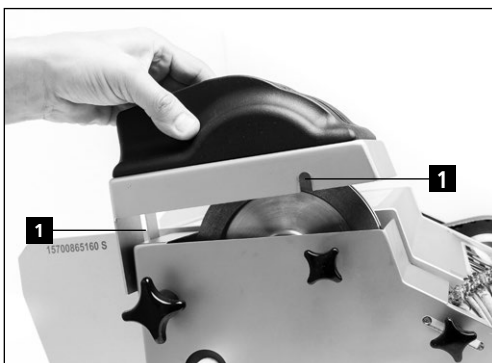
Figure 1-10 Monter le dispositif HV 150
