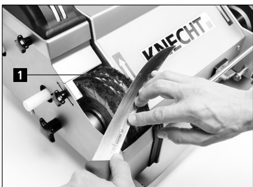
Figure 1-20 Démorfiler et polir le couteau à main
