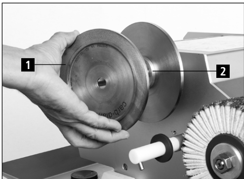
Figure 1-6 Monter le second disque d'affûtage CBN
