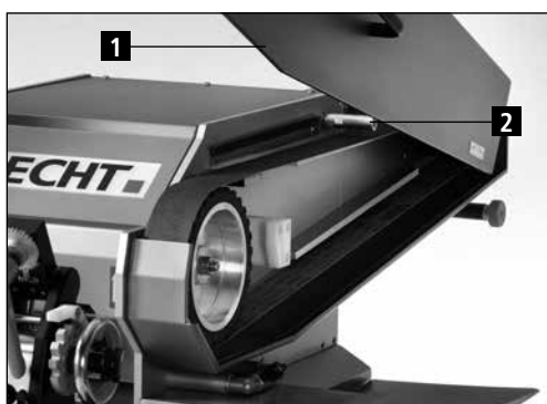
Figure 7-49 Ouvrir le capot de protection de la bande
