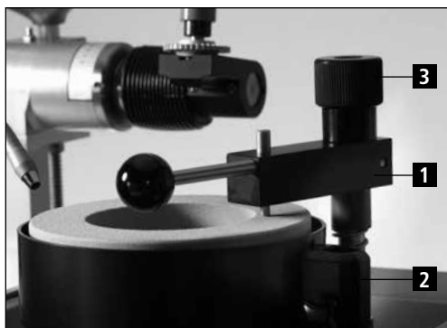
Figure 7-46 Dresser le disque d'affûtage
