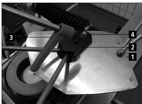
Figure 7-6 Fixer le support d'affûtage
