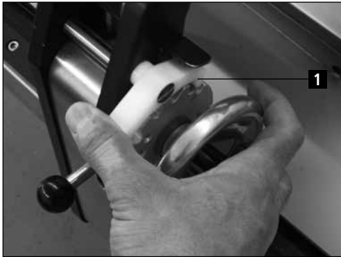
Figure 7-30 Affûter le tranchant du couteau
