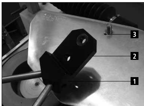
Figure 7-5 Monter le levier d'affûtage
