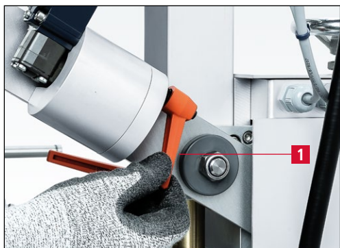
Figure 7-58 Desserrage du levier de blocage
