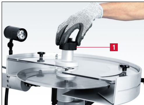
Figure 7-35 Desserrage du couteau circulaire
