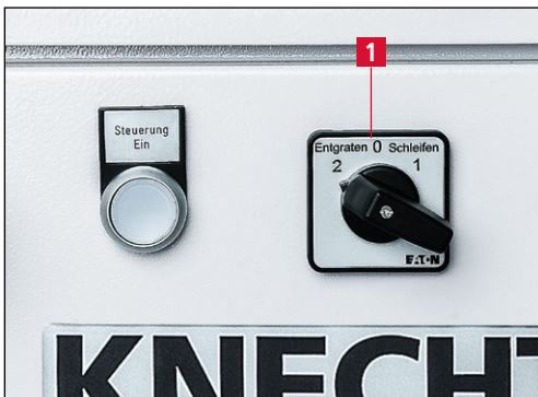
Figure 7-82 Mise en marche de l'affûteuse pour couteaux circulaires
