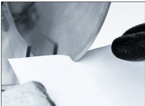
Figure 7-32 Contrôle de l'affûtage du couteau
