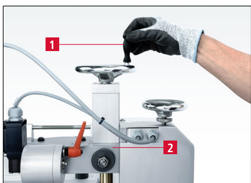
Figure 7-62 Alignement horizontal du bras d'affûtage
