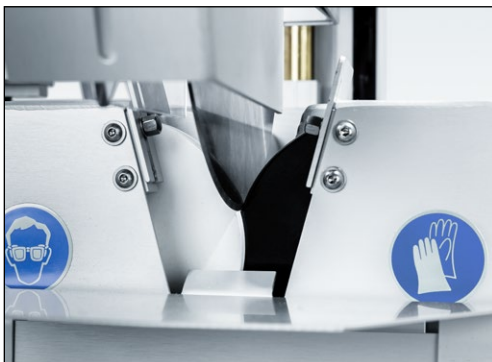
Figure 7-38 Utilisation d'un disque en acier
