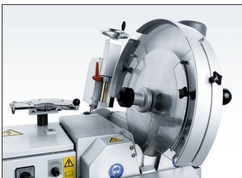
Figure 7-39 Inclinaison du dispositif d'affûtage
