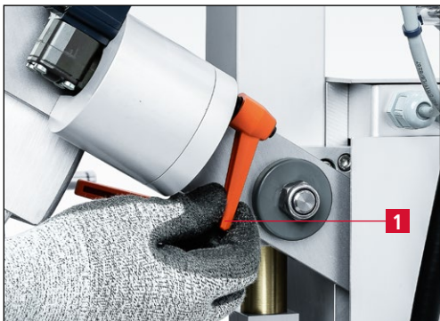
Figure 7-19 Desserrage du levier de blocage
