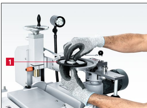
Figure 7-53 Insertion du couteau
