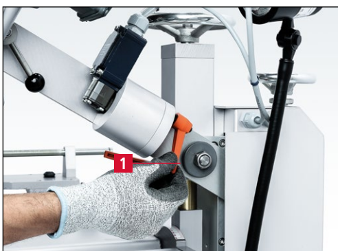
Figure 7-72 Desserrage du levier de blocage
