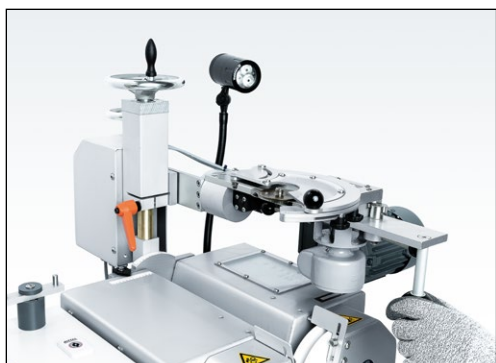
Figure 7-51 Dispositif d'affûtage pour couteaux circulaires en position de serrage
