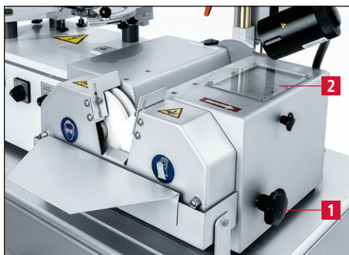
Figure 7-1 Affichage de l'angle d'affûtage
