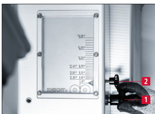
Figure 7-43 Blocage de la flèche indicatrice
