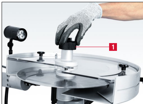
Figure 7-17 Mise en place de la vitre de protection
