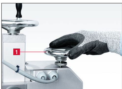
Figure 7-24 Rotation du volant à main «positionnement de précision» dans le sens horaire
