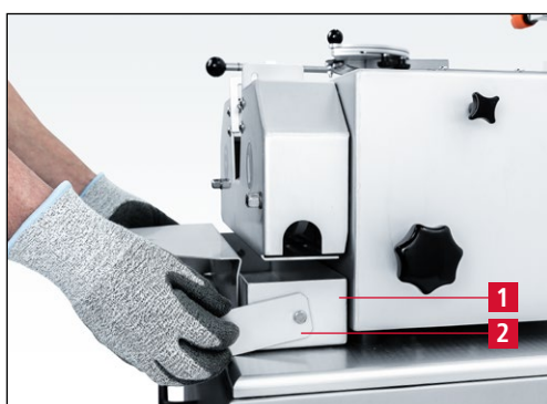
Figure 7-86 Dépose de la coupelle d'eau
