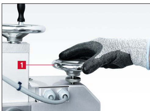
Figure 7-67 Rotation du volant à main «positionnement de précision» dans le sens antihoraire
