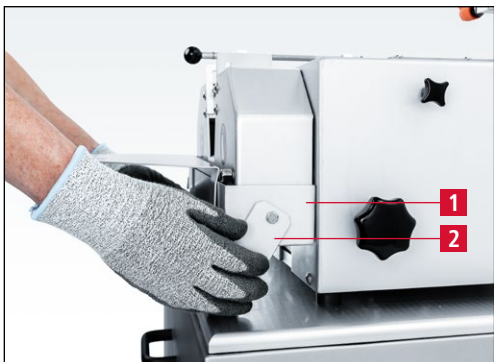
Figure 7-75 Escamotage de la coupelle d'eau
