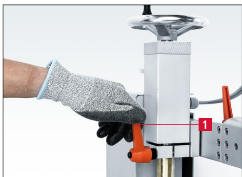
Figure 7-61 Ouverture du levier de serrage «réglage de la hauteur»
