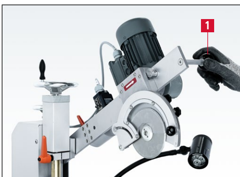
Figure 7-70 Rabattement du dispositif d'affûtage en position de repos
