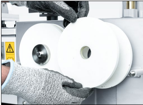
Figure 7-91 Dépose et remplacement par des disques d'affûtage neufs
