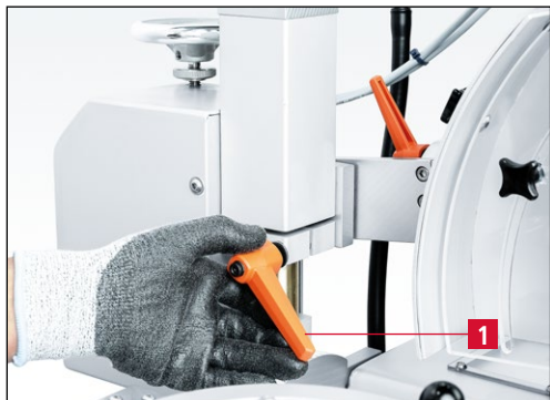
Figure 7-22 Desserrage du levier de blocage du «réglage de la hauteur»
