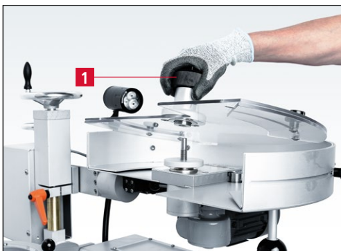
Figure 7-11 Retrait de l'écrou de serrage avec la vitre de protection
