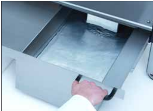
Figure 7-22 Changement de l'eau de refroidissement
