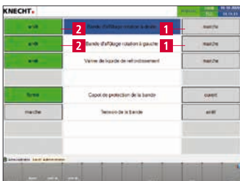
Figure 7-12 Fonctions manuelles «bande d'affûtage»
