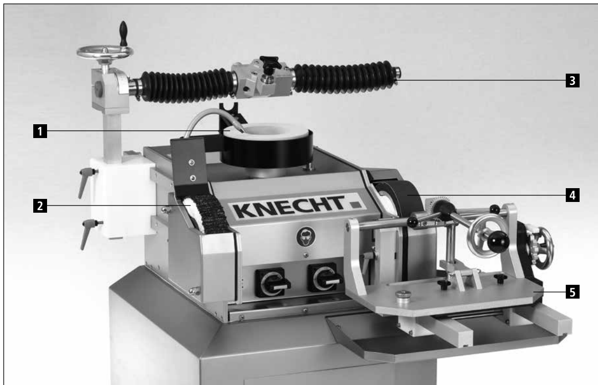
Figure 3-13 Vue globale de l'affûteuse (S 200 S modèle socle | HV 203 | HV 262)
