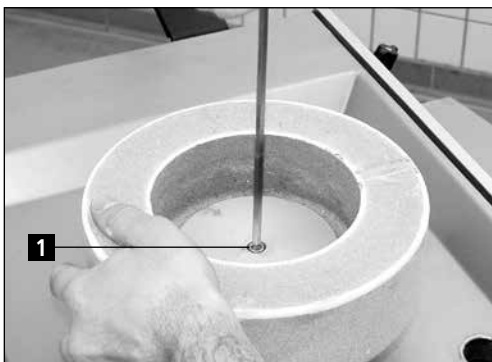
Figure 7-12 Remplacement de la meule
