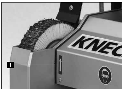
Figure 6-2 Vérifier le sens de rotation
