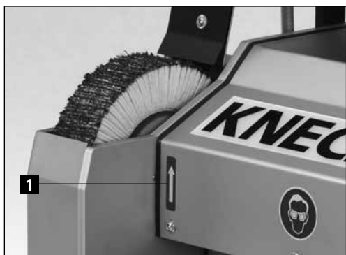
Figure 6-2 Vérifier le sens de rotation
