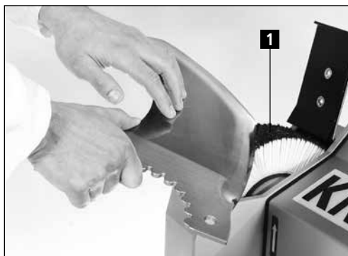
Figure 7-6 Polir/démorfiler le cutter
