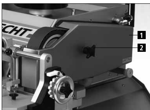
Figure 7-13 Ouvrir le capot de protection de la bande
