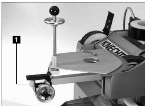
Figure 7-3 Dispositif d'affûtage par bande HV 261
