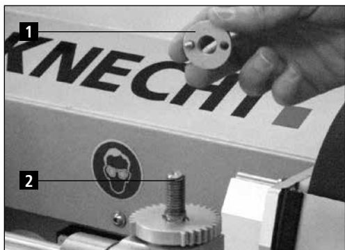
Figure 7-3 Disques d'écartement pour le réglage de l'angle d'affûtage
