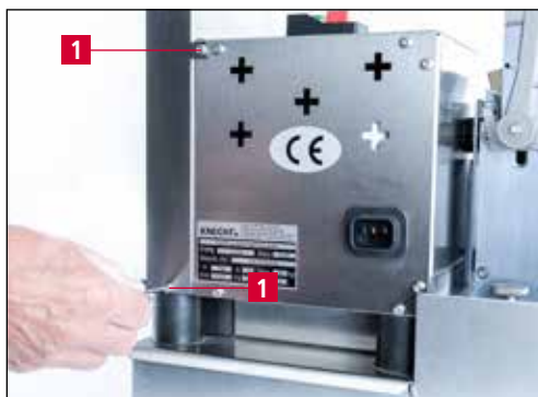
Figure 7-10 Dévisser le capot du disque de polissage
