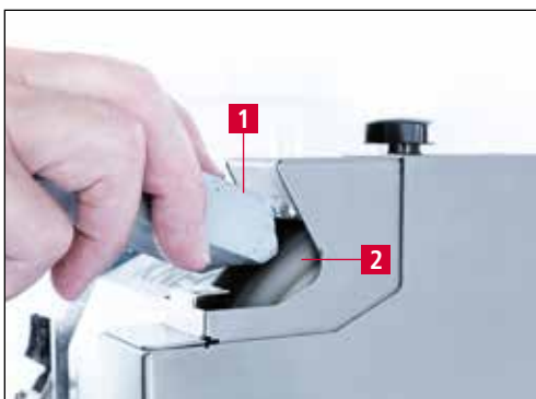
Figure 7-4 Appliquer la pâte de polissage
