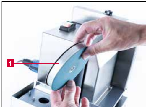
Figure 7-9 Monter une nouvelle paire de disques d'affûtage
