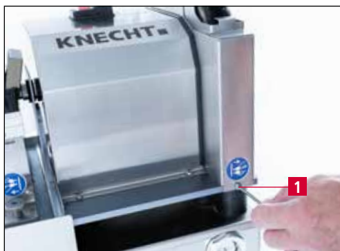
Figure 7-11 Dévisser le capot du disque de polissage
