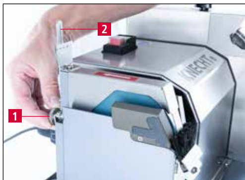
Figure 7-1 Régler l'angle d'affûtage
