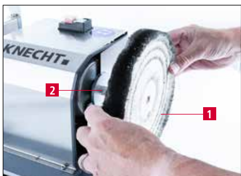
Figure 7-14 Remplacer le disque de polissage
