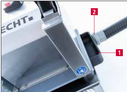
Figure 7-15 Tiroir à saletés avec raccord pour système d'aspiration
