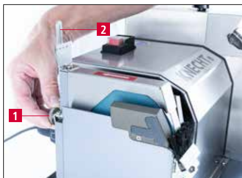
Figure 7-1 Régler l'angle d'affûtage
