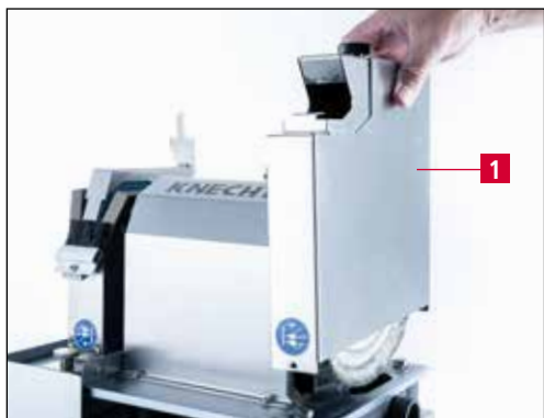
Figure 7-12 Retirer le capot du disque de polissage
