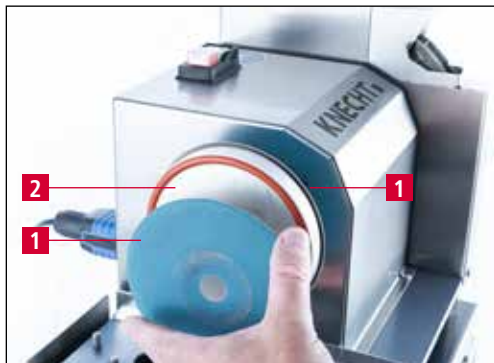
Figure 7-8 Retirer les disques d'affûtage usagés
